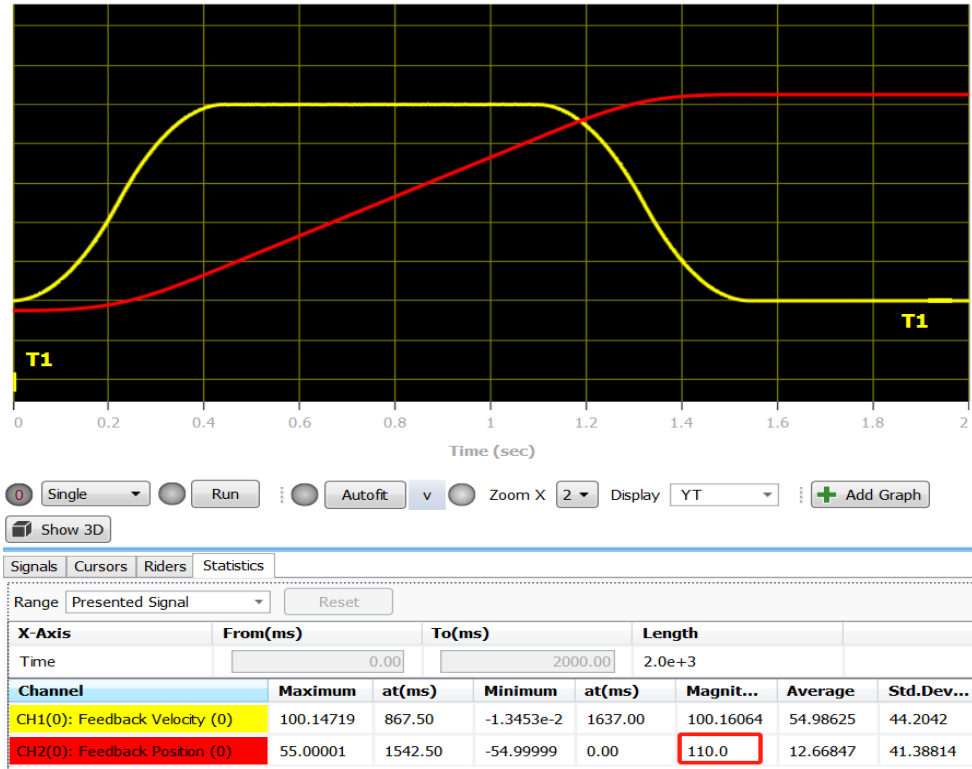
图 2：补偿后定位精度和双向重复定位精度
